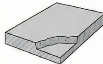
混凝土现浇板
