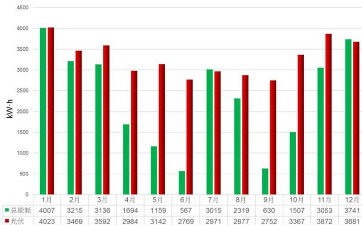
外，其他月份光伏发电量皆超过当月建筑系统总耗电量，建筑全年总能耗 28043.26kW · h，全年风光互补发电系统全年发电量为 39499.24kW · h，为建筑用能系统全年耗电量的 1.41 倍，从全年数
