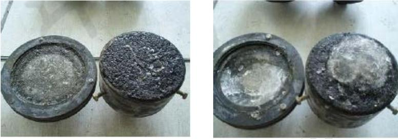
a) 冰-路粘结力较低时破坏界面示意图 b) 冰-路粘结力较高时破坏界面示意图
