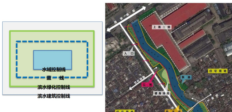
图 7-10 水系蓝线控制示意图
