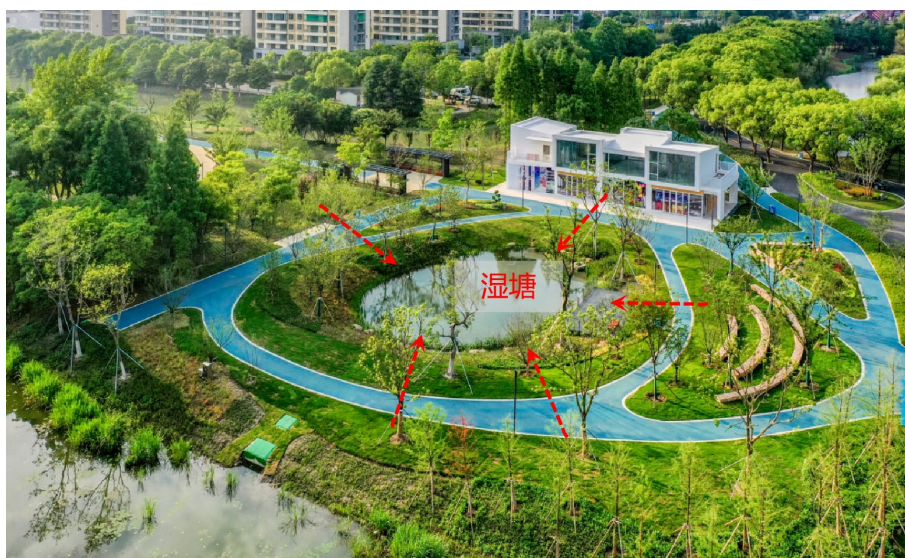
图 7-15 城市水系滨水湿塘汇水坡向图
